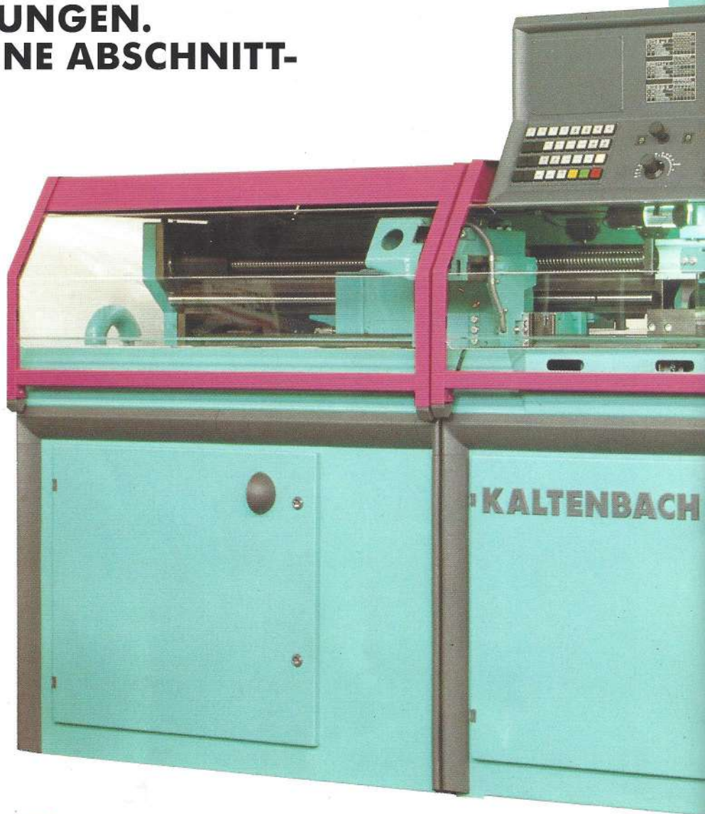
KKS 401 NA mit Abschnittgreifer, Sortiereinrichtung und Abschnittverteilung.
