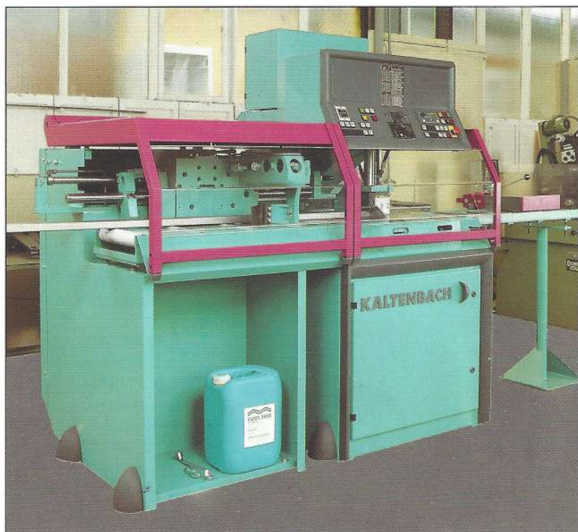
KKS 401 NA 600. Hydraulischer Material-Nachschubgreifer mit manueller Längeneinstellung nach Skala.
