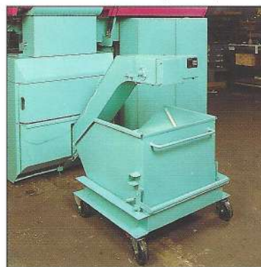
Automatischer Späneförderer (Abwurfhöhe 880 mm) und kipperbarer Spänewagen.
