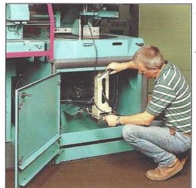
Großflächige, elektrisch gesicherte Kastentür für einfachen Wechsel des Sägeblattes. Späneschublade. Maschinenleuchte.
