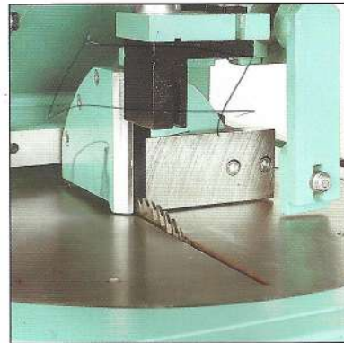
Auswechselbarer Werkstückanschlag für 90°- Schnitte (min. Reststücklänge 55 mm) und Schrägschnitte nach einer Seite.
