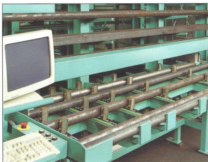
Einlagerstation mit Vorlagermagazin, automatischer Stablängenmessung und Zusatz-Terminal.
