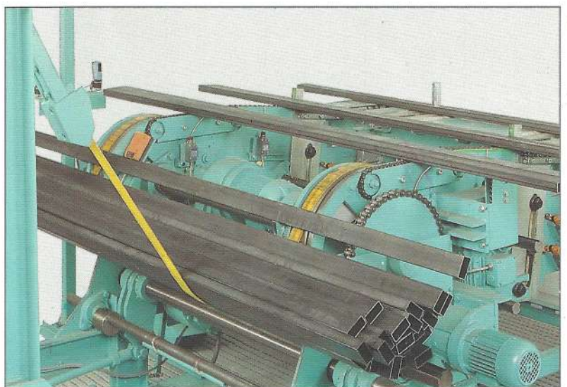
Magazin zur Vorlagerung und Vereinzelnung von Materialbunden.
