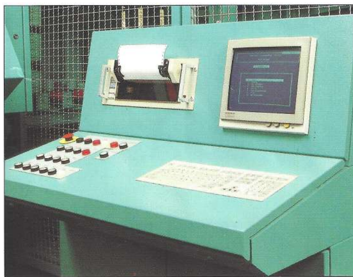
Bedienpult mit eingebautem Lagerverwaltungsrechner und System-Drucker.
